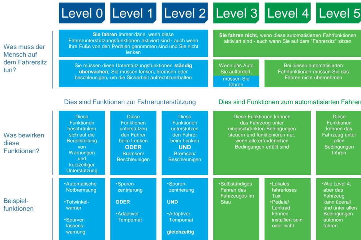
Abbildung 1.1: Die sechs Level der Fahrzeugautomatisierung nach SAE<sup>2</sup>
