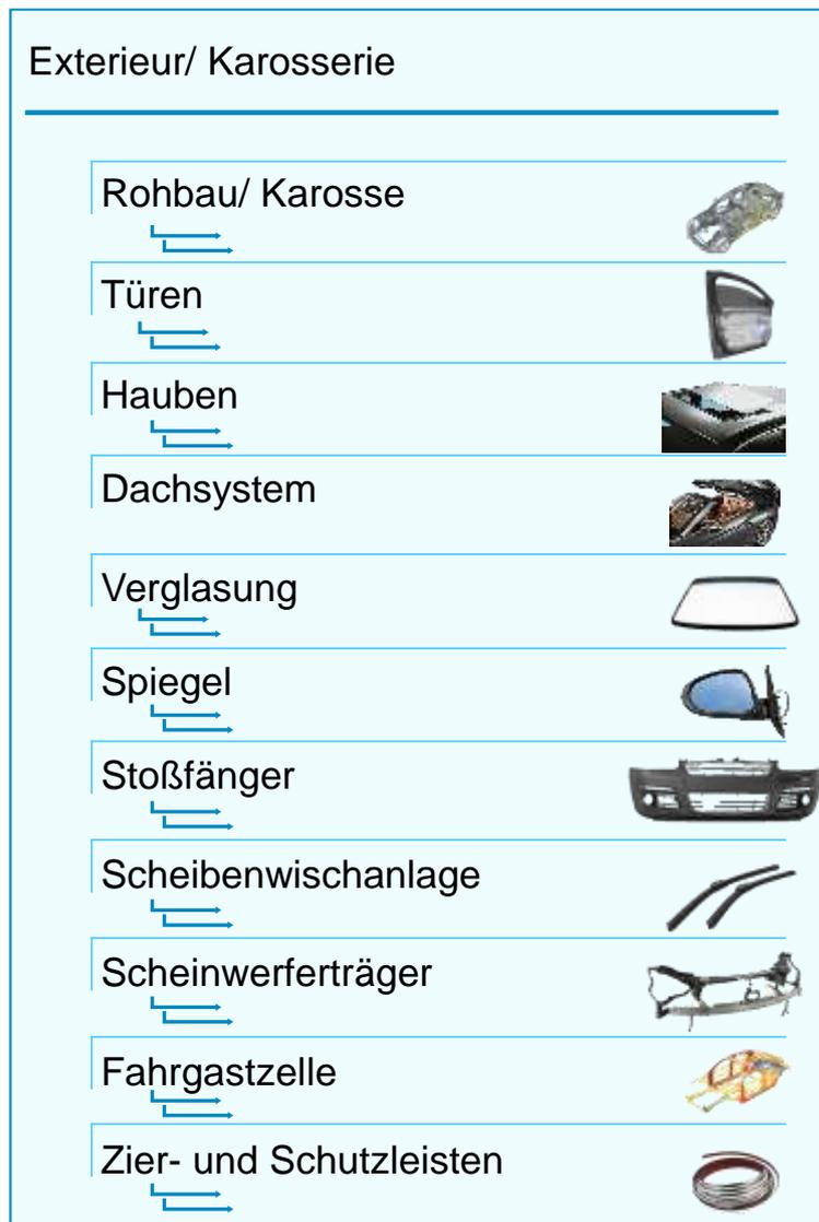
Abbildung 2.16: Teilsysteme im Bereich Exterieur/ Karosserie<sup>60</sup>
