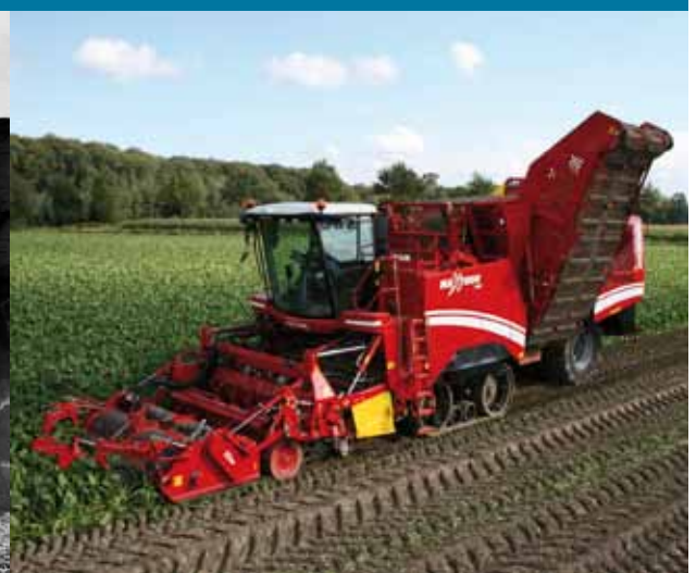
2015: „precision farming“ – deutsches Premiumprodukt und „hidden champion“: Der bodenschonende und wendige Rübenroder erntet und legt spielend Rübenmieten mit 10 Metern Breite an.
