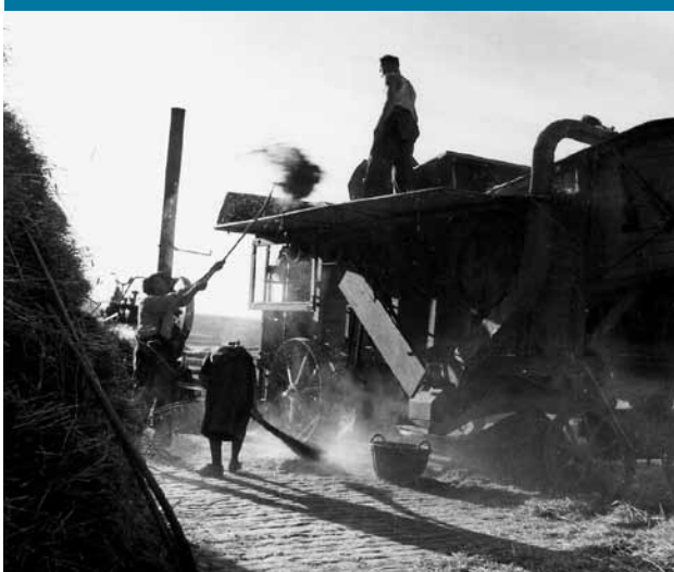
Dreschmaschine um 1920. Das anderenorts geerntete Getreide muss mitsamt Halm und Ähre herangefahren werden; die Dampfmaschine stellt die notwendige Kraft bereit.
